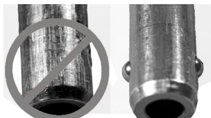
Fig. 18: perno sinistro - rimosso a causa dell'usura e a causa del fatto che i perni di ritenzione non funzionano correttamente; perno destro - in buone condizioni operative
