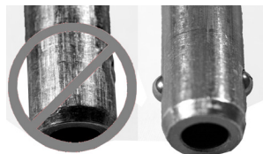
Fig. 31: perno sinistro - rimosso a causa dell'usura e a causa del fatto che i perni di ritenzione non funzionano correttamente; perno destro - in buone condizioni operative
