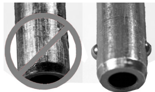
Figura 18 Pasador izquierdo, retirado debido al desgaste y pasadores de retención no funcionando adecuadamente; pasador derecho, en buenas condiciones de funcionamiento
