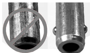
fig. 31: Pasador izquierdo - retirado debido al desgaste y los pasadores de retención no funcionan correctamente; Pasador derecho - en buenas condiciones de funcionamiento
