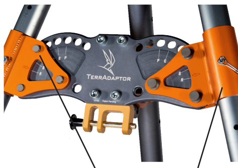
Figura 7 Abrazaderas de pata de compensación (izquierda, mirando hacia el frente; derecha, mirando hacia atrás) para propósitos ilustrativos. Las buenas prácticas tienen ambas abrazaderas de pata de compensación mirando hacia el frente en una configuración de tres patas típica
