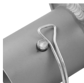
Figura 3 Pasador de acoplamiento de pata indebidamente asegurado
