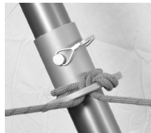
Figura 24 Anillo de amarre utilizado cerca de la sección de pie para estabilidad incrementada
