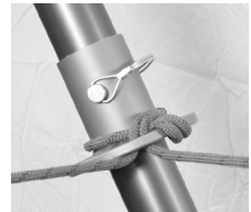
Abb. 24 Für erhöhte Stabilität nahe des Fußabschnitts eingesetzter Verzurr-Ring
