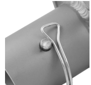
Abb. 3 Nicht ordnungsgemäß gesicherter Beinkupplungsstift
