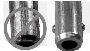
Abb. 31: Linker Stift – aufgrund von Verschleiß und nicht ordnungsgemäß funktionierender Arretierung entsorgt; rechter Stift – in gutem Zustand
