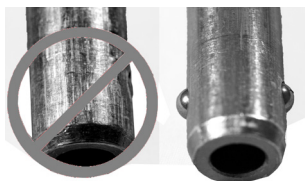
Abb. 18 Linker Stift - nicht mehr verwendet aufgrund Verschleiß und weil Raststift nicht richtig funktioniert, Rechter Stift - in gutem Zustand
