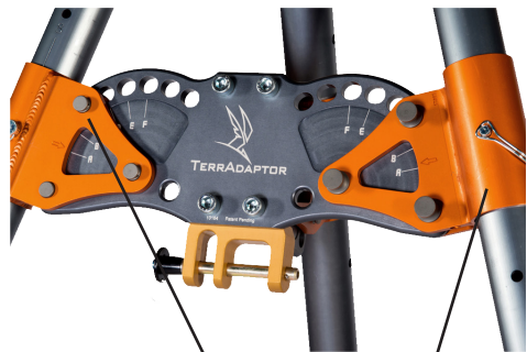
Abb. 7 Versetzte Beinklemmen (linke nach vorn weisend; rechte nach hinten weisend) zur Veranschaulichung. Bewährte Verfahren verwenden beide versetzten Beinklemmen nach vorn weisend in einer typischen Dreibeinstativkonfiguration
